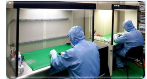
＜配备离子发生器的洁净室＞
