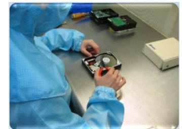
＜物理损坏修复作业＞
